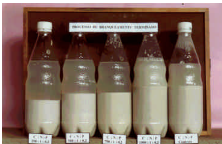
FIGURA 3 – Término do branqueamento biológico do caulim
